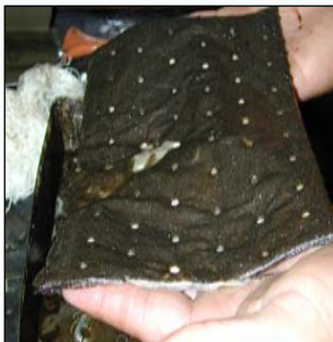
Limpieza de un derrame de hidrocarburos en una laguna con colchonetas PAD204
